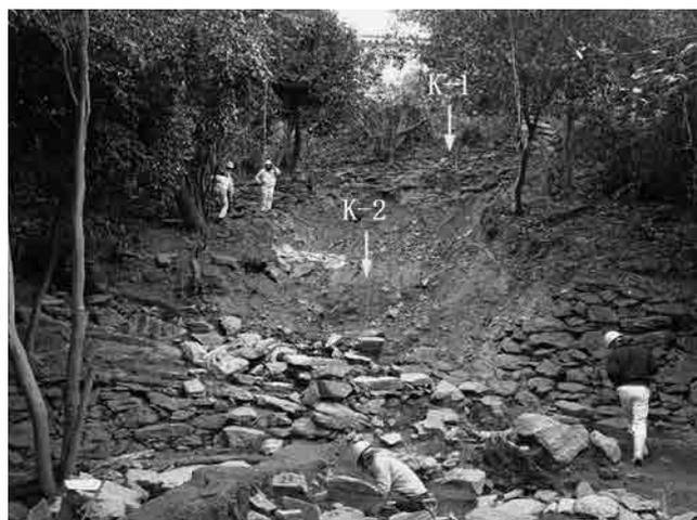
第61図 水の手郭崩壊斜面発掘調査時の状況と簡易動的コーン貫入試験位置
